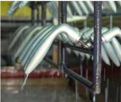
**2. Vorbehandlungen:** In dieser Phase werden eine Reihe von Behandlungen durchgeführt, die für die Optik und vor allem auch für die Korrosionsbeständigkeit und Haftfestigkeit des Lacks äußerst wichtig sind.
