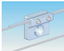
Das Ende der Drahtseilverbindung wird in einer Klemmbacke fixiert
