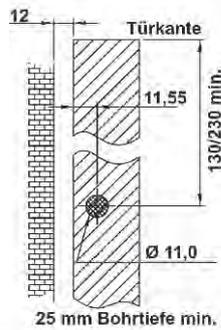
Die Entfernung der Bohrung zur Türkante von 130 mm (Fangstopper) ist ein Mindestmaß. Je nach Einbausituation kann die Entfernung auch vergrößert werden.
