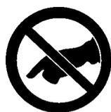
***Gefahr: Rotierende Teile wie Schneidwelle, Trennscheibe etc. während des Betriebes nicht berühren!***
