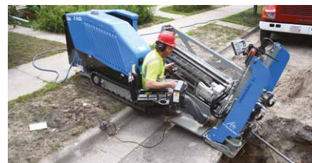
Einfache Einstellung des Neigungswinkels von 11-17°
