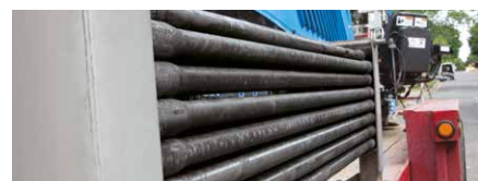
Gestängemagazin Kapazität 61 Meter, optional 76 Meter
