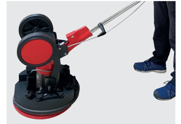
Deichsel auf Kopf stellen für maximales Arbeitsgewicht
