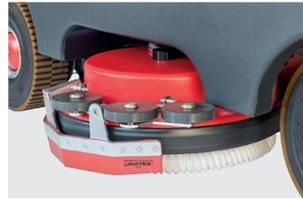
Schwenkbarer Bürstenkopf für randnahe Reinigen
