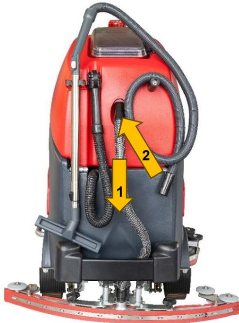
Entfernen Sie oben den Saugschlauch von der Saugdüse der Maschine (1) und montieren Sie den Saugschlauch vom Wassersaug-Set (2).
