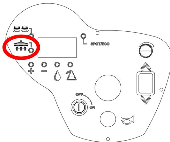
Durch einen langen Tastendruck (> 3 Sekunden) der Saugfunktion, schaltet die Saugfunktion auch bei stillstehender Maschine ein, der Fahrersitz muss nicht besetzt sein. Schalten Sie nach getaner Arbeit die Saugfunktion durch einen kurzen Tastendruck wieder aus.
