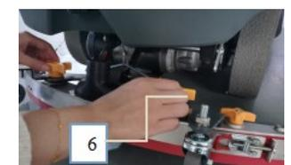
11. Zum Entleeren des Frischwassertanks den Knopf (1) nach unten schieben.
