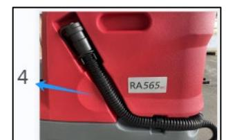
6. Ziehen Sie den Saugschlauch (5) von der Saugmuffe ab.
