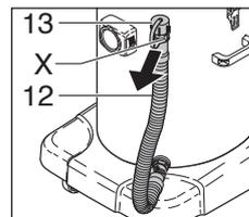
☞ Entleerungsschlauch (12) von der Halterung (X) abnehmen.
