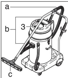
☞ Wickeln Sie das Netzkabel (9) vollständig ab. Montieren Sie das gewünschte Zubehör (z.B. Gummi Bodendüse (c)).
