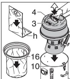
☞ Sauger ausschalten (3). Die 2 Tank-Arretierungsriegel (10) öffnen und Motorkopf (4) nach oben abnehmen.
