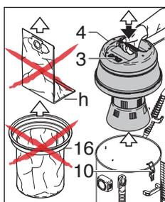
☞ Ventouse avec interrupteur (3) hors tension. La barre de verrouillage 2-réservoir (10) Ouvrir et retirer la tête du moteur (4) vers le haut.
