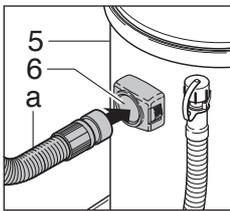
☞ Saugschlauch (a) in den Schlauchanschluss (6) am Edelstahltank (5) anschließen.
