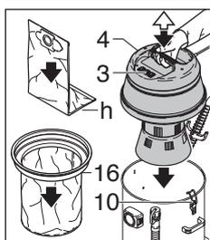
☞ Eteignez l'aspirateur (3). Ouvrez les clips de réservoir (10) et retirer le capot du moteur (4).
