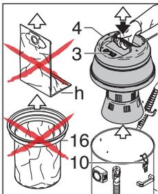
☞ Sauger ausschalten (3). Die 2 Tank-Arretierungsriegel (10) öffnen und Motorkopf (4) nach oben abnehmen.
