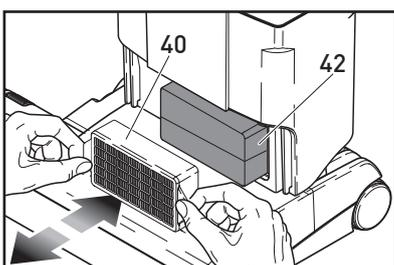
Danach muss der Schalldämpfer mit der abge-schrägten Seite nach links wieder in das Gerät eingesetzt werden. Anschließend auch den Ab-luftfilter wieder einsetzen.
